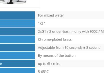
Min 0,5 bar - Max 6 bar (Recommended 2-4 bar)
